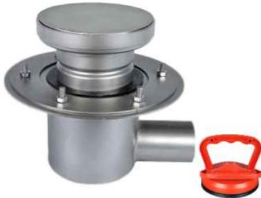
Sumidero de Ø160 mm con cuerpo redondeado, sifónico, con filtro y tapa extraíbles. Tapa con junta perimetral y apertura mediante ventosa. Salida horizontal de Ø110 mm. Acabado decapado. El filtro puede usarse en sumideros con o sin sifón extraíble.
